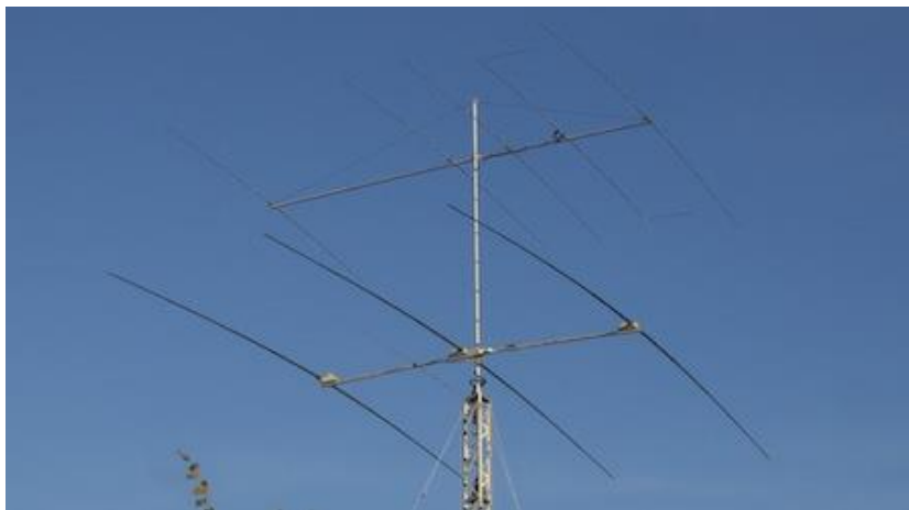
Figura 19 - Yagi de 3 elementos para 15m (monobanda) e yagi de 5 elementos (OPDES) para 6m mais acima no mastro. Note que o mastro gira e aponta as duas na mesma direção.
