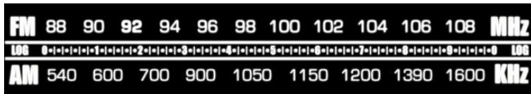
Figura 6 - Dial – antigo mostrador de rádio AM/FM. As frequências crescem para a direita – forma mais comum de apresentar o espectro eletromagnético.
