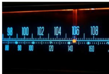
Figura 7 - O ponteiro vermelho se desloca, indicando a frequência recebida - 106 (?) A escala de cima é na “faixa de FM” em MHz e a de baixo é na “faixa de AM” em dezenas de KHz.
